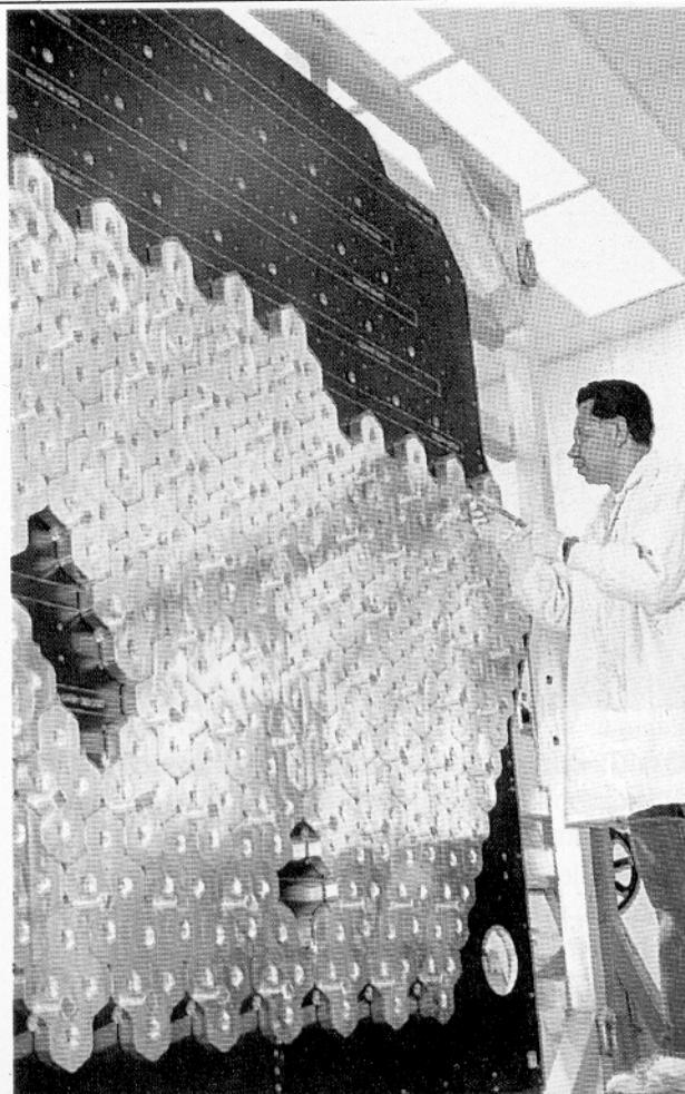
Slika 4. Tehničar radi na filtrima inženjerskog modela antenskog niza od 127 elemenata za ICO MEO sistem (u srednjoj Zemljinoj orbiti). Svaki satelit će imati ovakva dva niza - jedan za slanje i drugi za prijem poziva od strane korisnika sistema.
